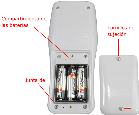
Figura 1: Instalación de las baterías
