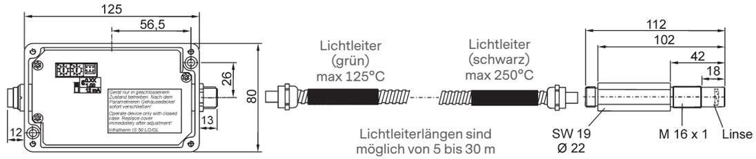
Luftpülvorsatz mit Inconelrohr
