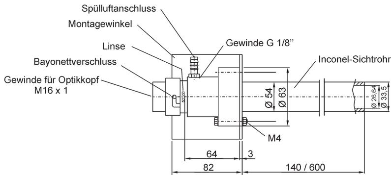
Luftpülvorsatz mit Keramikrohr
