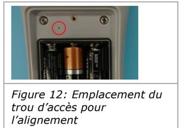
Figure 12: Emplacement du trou d'accès pour l'alignement
