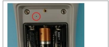
*Figura 12: Ubicación del orificio de acceso a la alineación*
